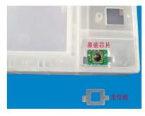
Зафиксируйте оригинальный чип на перезаправляемом картридже
