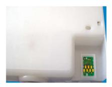
Аккуратно снимите чип с оригинального картриджа и установите на перезаправляемый картридж в месте для второго чипа
