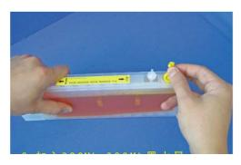
Закройте пробкой специальное отверстие для заправки картриджа и вставьте пылевой фильтр
